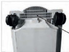
Рис. 42 – Расположение фильтра грубой очистки
