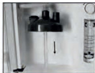
Рис. 49 – Расположение фильтра грубой очистки
